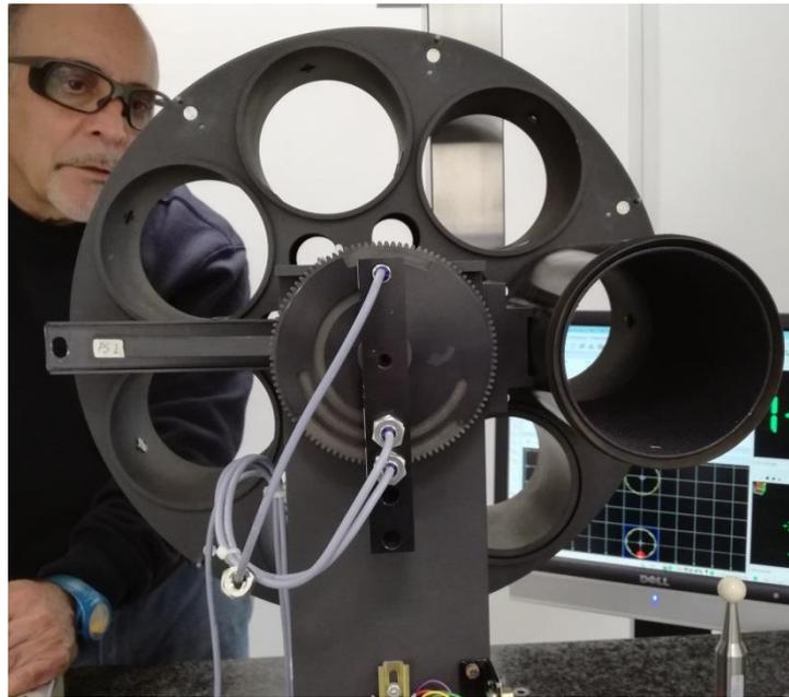
*Figura 1 - 12 Realización de pruebas de repetibilidad con la máquina de medición MITUTOYO*
