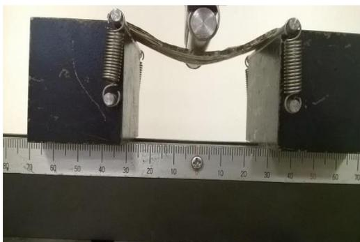
A los 17 N hay una pequeña caída de la carga debida que comienza la rotura entre las capas superiores por falta de resina. Termina finalmente la rotura al separarse las capas.
