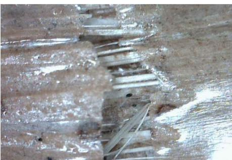
La rotura se produce en la mordaza, pero en este caso se rompen solo una capa de fibra de plátano de las tres capas que la conforman.
