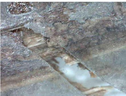
Cerca de la mordaza se observa la fractura parcial de la probeta en dirección diagonal.
