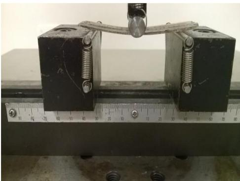
El fallo que presenta es igual que la probeta FP1, donde no hay rotura en la capa inferior sino entre las capas.
