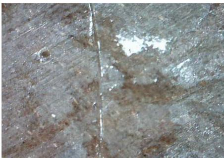
En este caso se producen varias fisuras del poliéster a lo largo de la probeta sin afectar a las fibras.
