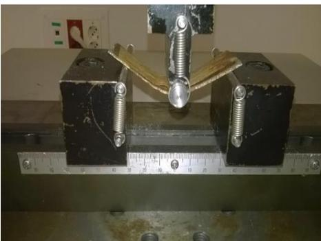
La fractura en esta probeta es la misma que en FP1 y FP3, donde no hay rotura en la capa inferior sino entre las capas.
