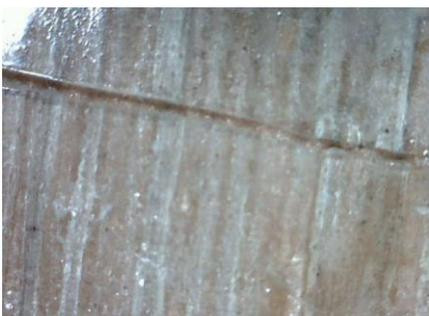
La fractura de la probeta es por una cara, afectando solo a una capa que la compone. El comportamiento en la gráfica explica que cuando rompe el poliéster continúa hasta la que fibra también se desgarró.
