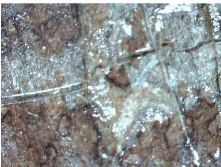
La rotura de las fibras se aprecia a mitad de la probeta con una forma escalonada. El salto en la gráfica viene dado a que primero rompe el poliéster y después le sigue la fibra de plátano.
