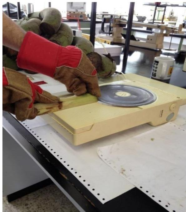
Figura 4.2 Laminación de las fibras
