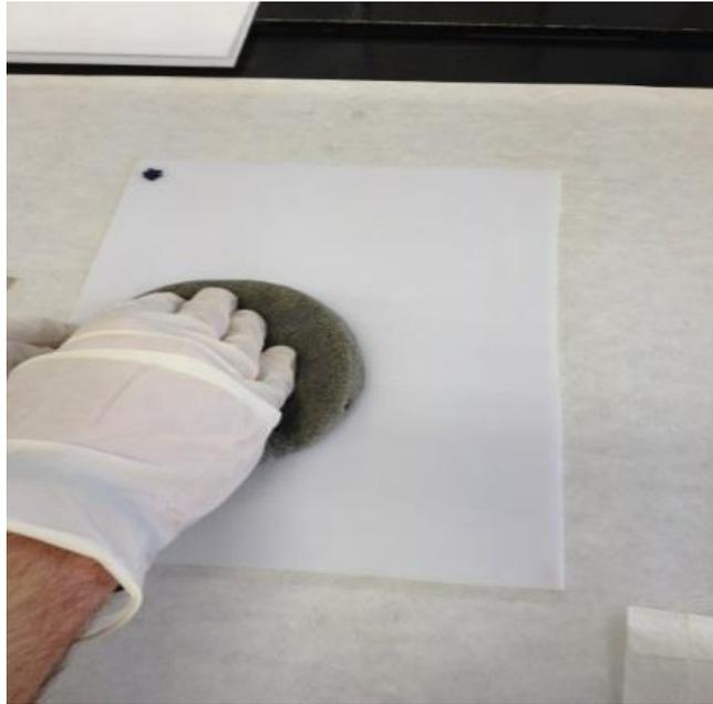
Figura 5.2 Aplicación de la cera desmoldante
