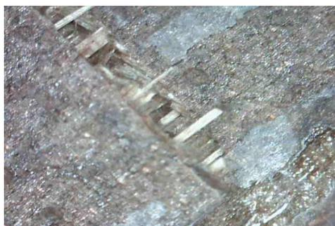
La fractura se efectuó en el centro de la probeta pero solo dañando a una capa de las fibras de plátano y el resto inalteradas, es por eso la desviación en la gráfica.
