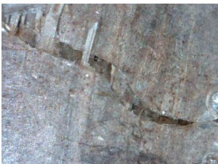
Se produce la rotura casi a la mitad de la probeta. Se fractura uno de los lados, dañando a una capa de las fibras de plátano.
