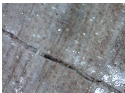
La fractura de la probeta se efectua de forma continua en la zona de la mordaza, quedando afectado un lado de la probeta, sin llegar a ser completa la rotura.
