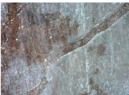
La rotura de la probeta es en forma diagonal afectando únicamente al poliéster. Los saltos vienen dados que aparte de la rotura principal se fue fracturando el poliéster en varios puntos a la vez.
