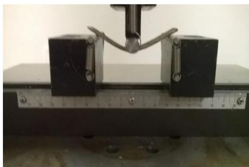
La rotura de la probeta se produce en la capa inferior por tracción, además de una fisura en la capa superior.
