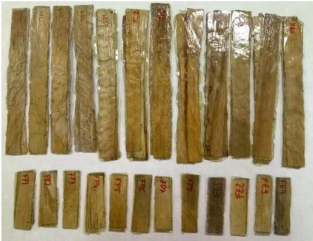
Figura 5.6 Probeta reforzada con fibra de plátano
