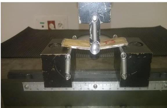
Tiene un comportamiento como la muestra FE1 y la rotura de la probeta se produce en la capa inferior por tracción.
