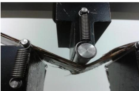
La rotura inicial se produce en la capa inferior por tracción. En la curva fuerza-deflexión se observa que a los 15 N rompe por un lateral y continua resistiendo hasta rompe por completa.
