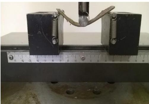
En este caso se mantiene unos instantes alrededor de los 10 N de carga hasta que se produce la rotura por tracción en la capa inferior.
