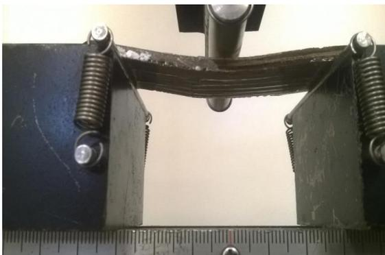
En este caso empieza a fracturarse por un lado pero continua cargando hasta que rompe por el otro lateral y acaba con la rotura completa de la capa inferior. Este efecto se refleja en los saltos de la gráfica fuerza-deflexión.
