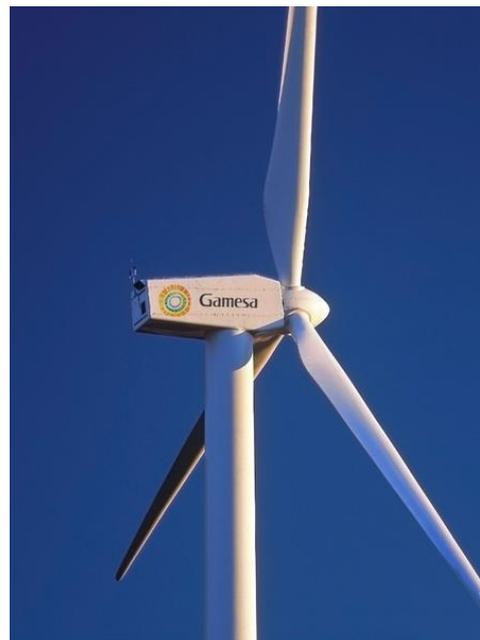
**Imagen 54. Aerogenerador G58-850 kW de Gamesa**
