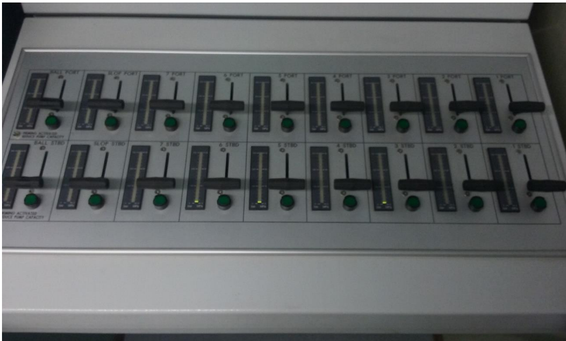
Ilustración 29; Regulador de bombas de descarga y lastre. Fuente; Trabajo de campo.
