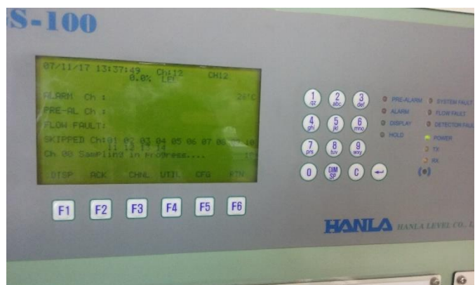
Ilustración 43; Pantalla LCD que muestra toda la información de la atm del tanque. Fuente; Trabajo de campo.
