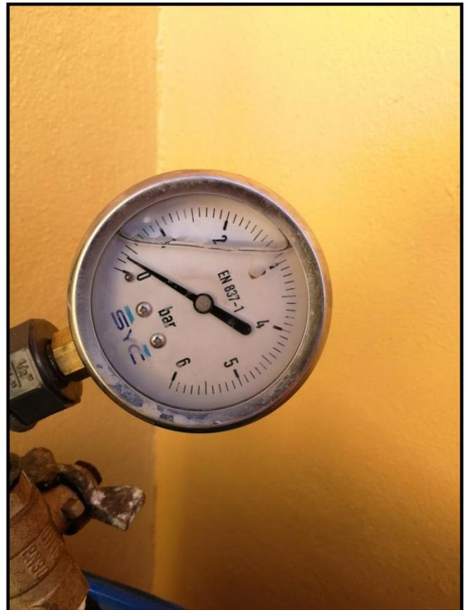
Foto 23: Detalle del manómetro Bourdon
