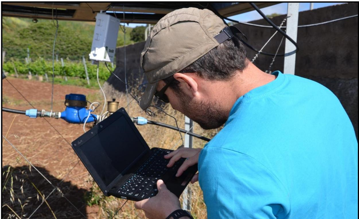
**Foto 35: Configurando el registrador de datos conectado al contador.**
