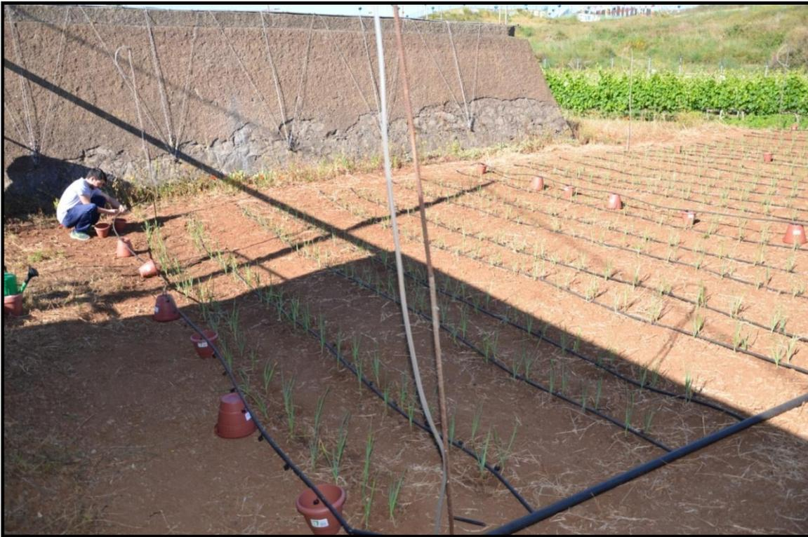
Foto 30: Evaluación de la uniformidad de riego de la instalación.
