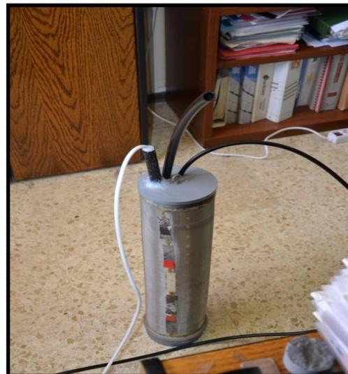
**Foto 8: Filtro con la salida de la sonda de nivel.**
