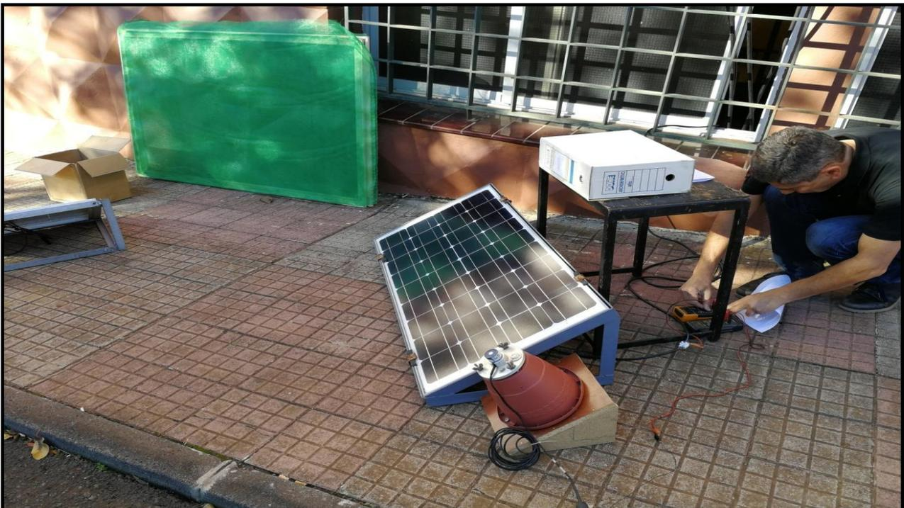
**Foto 18: Panel solar y célula radiométrica. Al fondo, paneles de malla para modular la radiación incidente.**
