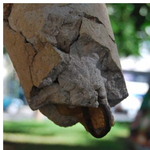
Imagen 14. - Varilla de hierro dulce en forma de "U". Único anclaje para el injerto de un segundo pie.
