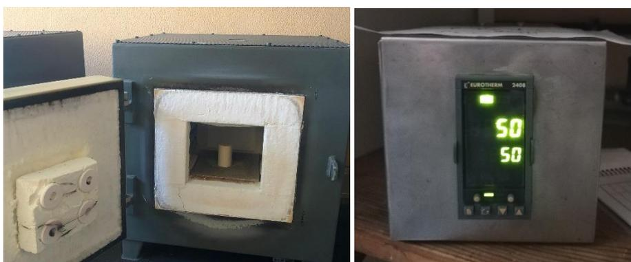
*Fig 9. En la izquierda se muestra un horno marca Gallour y en la derecha su controlador*
