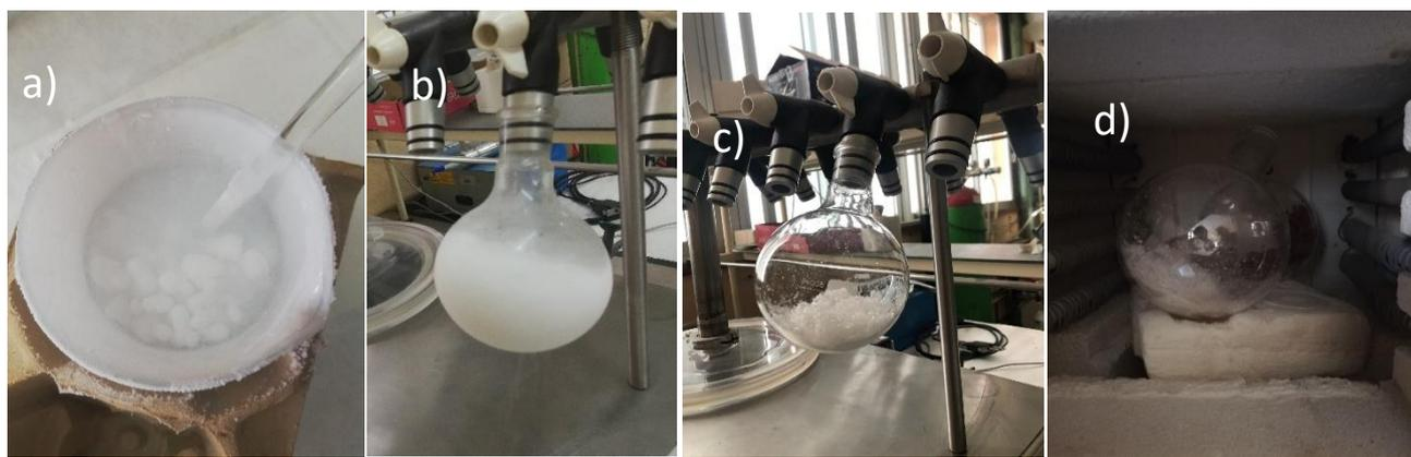
Fig 21. a) Disolución congelada, b) inicio de la liofilización, c) producto al finalizar el proceso de liofilización y d) tratamiento térmico
