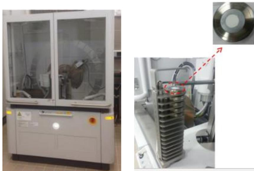
Fig 24. Difractómetro Empyrean PANalytical (izq) y cargador automático de muestras (der)
