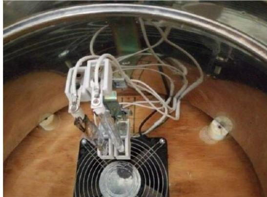
Fig 14. Imagen de las lámparas Uv (izq) y visible (der)
