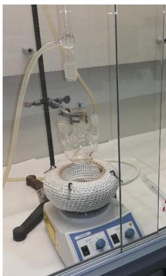
Fig 19. Imagen de un montaje experimental acorde a un reflujo
