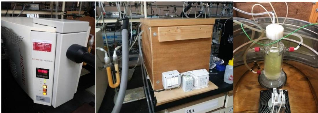
Fig 11. Espectrómetro de masas (izq), sistema fotocatalítico (centro) y reactor (izq)
