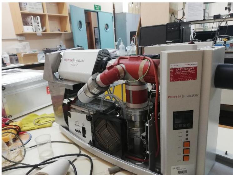
Fig 12. Interior del espectrómetro de masas utilizado en el presente trabajo.
