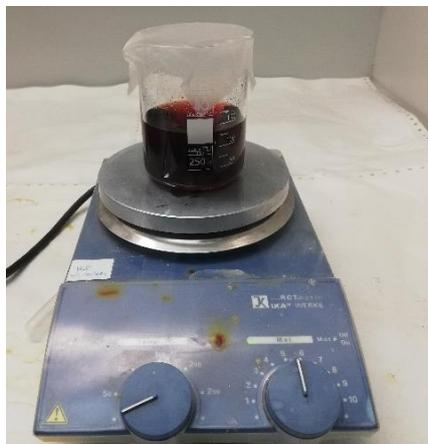
Fig 30. Disolución de iones metálicos que dará lugar al compuesto BSCF.
