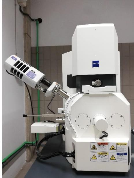
Fig 26. Microscopio SEM ZEISS EVO 15 con resolución de 2 nm
