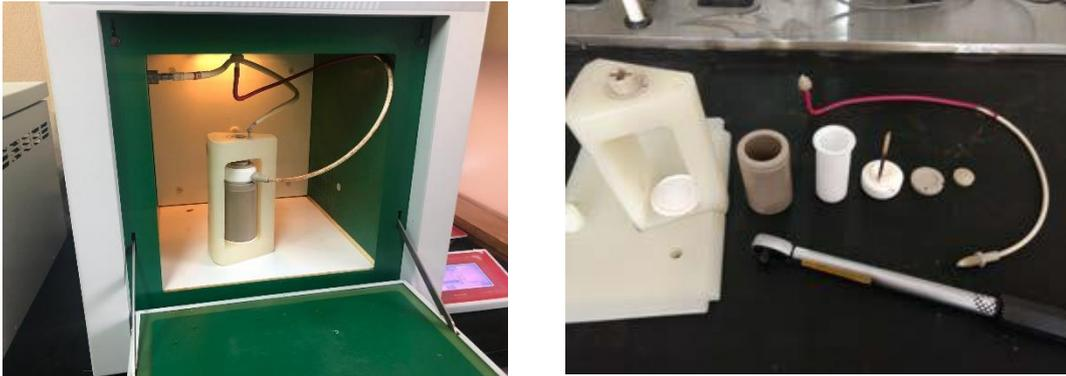
Fig 10. En la izquierda se muestra la estación microondas Milestone Ethos Touch Control y en la derecha un reactor (recipiente blanco) y el mecanismo de cierre (resto de componentes)
