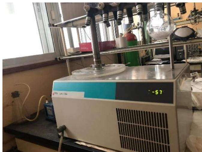
Fig 17. Equipo de liofilización Heto Lyolab 3000
