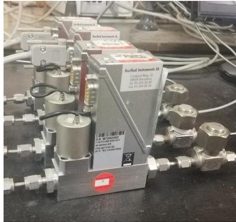
Fig 16. Controlador de flujo másico utilizado para regular el caudal de nitrógeno
