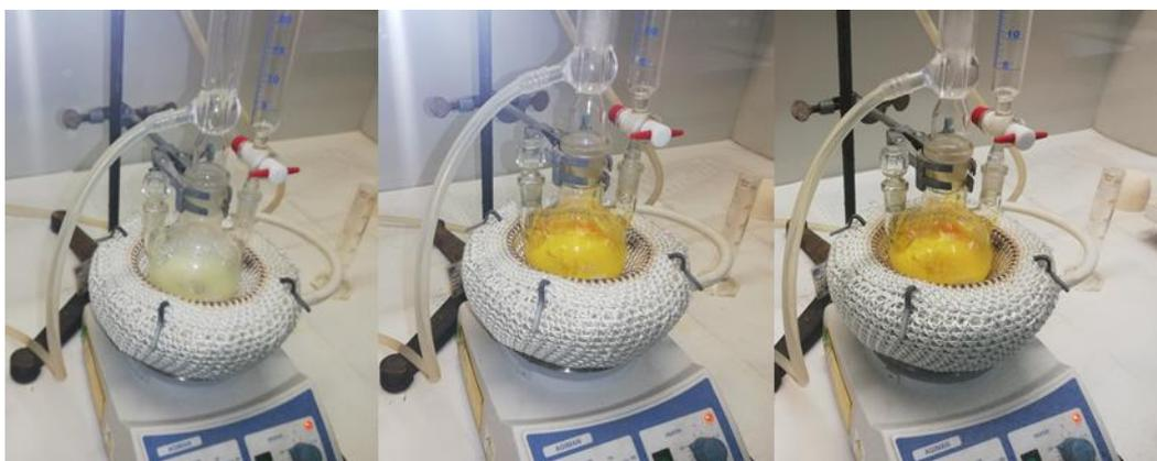
Fig 28. Síntesis de catalizador  $g\text{-C}_3\text{N}_4/\text{CdS}$  al comiendo del reflujo (izq), al cabo de 40 minutos (centro) y al finalizar el reflujo (der)
