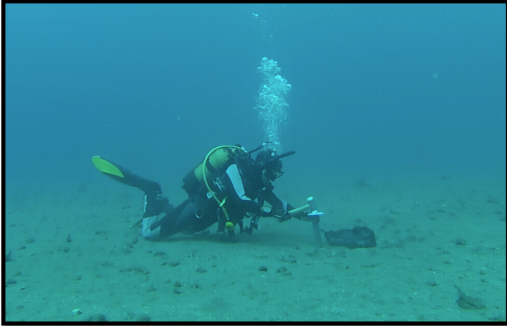
Figura 3. Buceadora realizando la recolección de muestras, clavado en el sedimento de los cilindros de PVC (cores).
