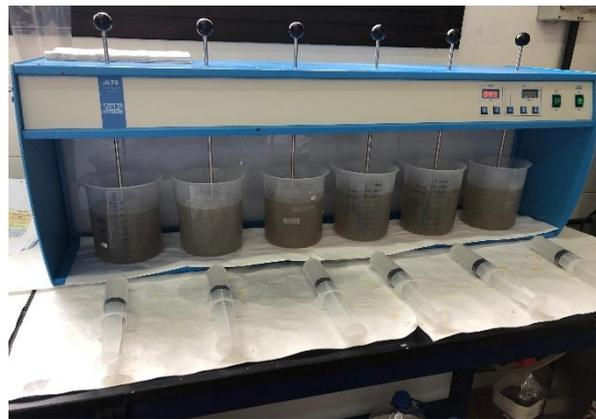
**Figura 3.3.** Jar-test en el que ha tenido lugar el proceso de coagulación-floculación.
