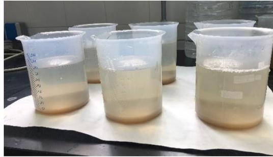
**Figura 3.4.** Proceso de sedimentación del agua residual doméstica.
