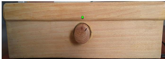
Figura 5.2: Vista frontal de la caja terminada. Se observa el control de volumen y el indicador de encendido.
