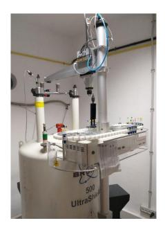
Imagen 3. Espectrómetro Bruker Avance II 500
