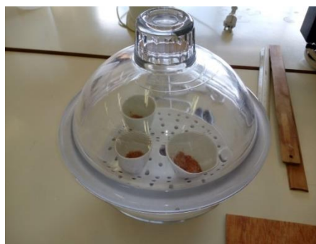
Fotografía 4.2.3. Desecador con muestras de lactosuero para ST y SV
