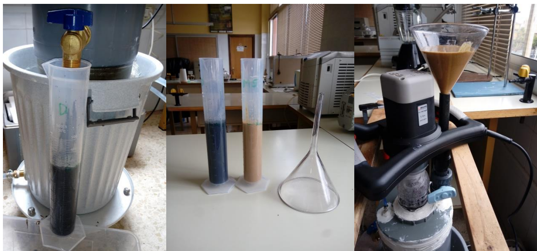
Fotografía 4.4.3. Descarga y alimentación del reactor.
