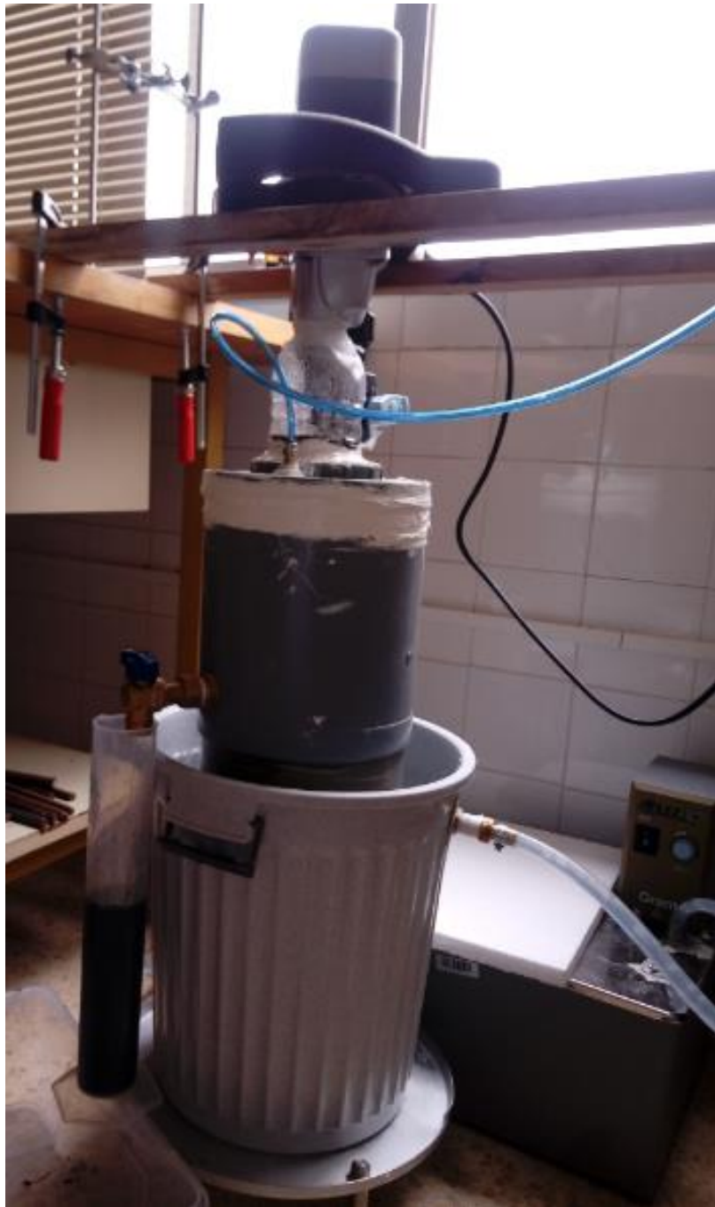
Fotografía 4.4.2 Reactor anaeróbico en continuo
