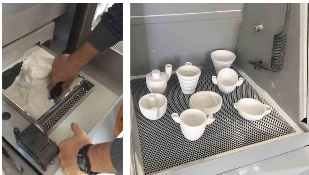
Imagen 23. Imágenes del proceso de extracción de las piezas. Fuente propia.
