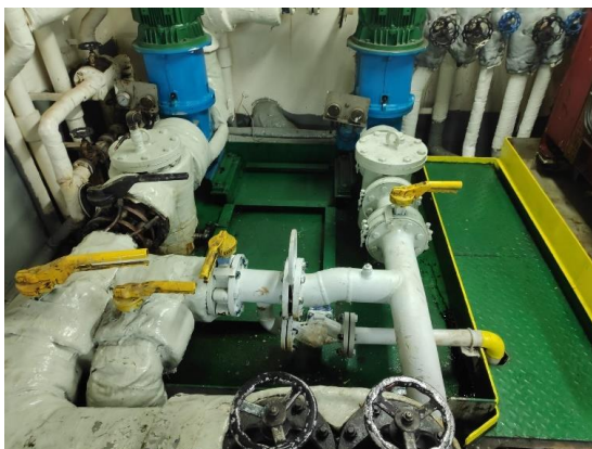
Ilustración 11: “Plano de válvulas de consumo y trasiego de Fuel-oil”
