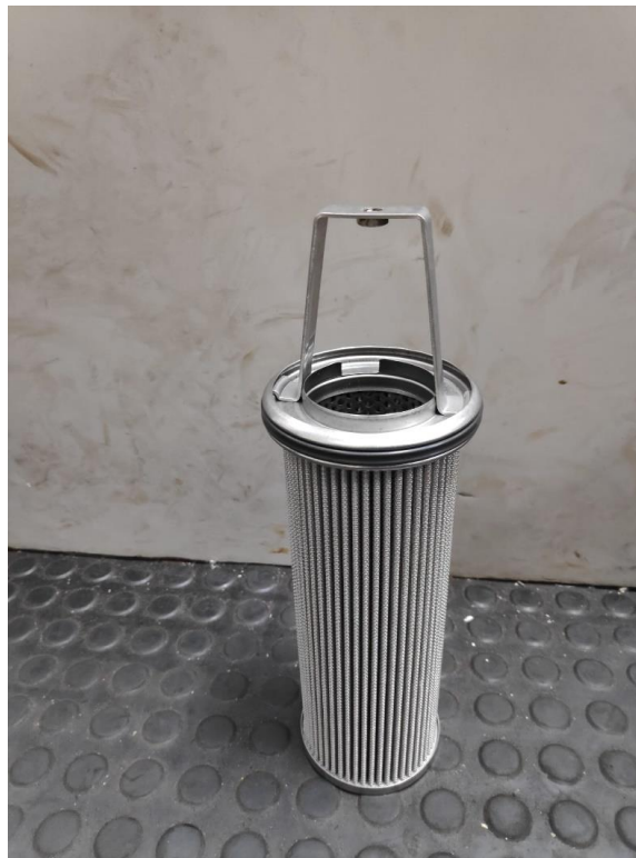
Ilustración 36: Filtro nuevo de combustible para Motores Auxiliares.
