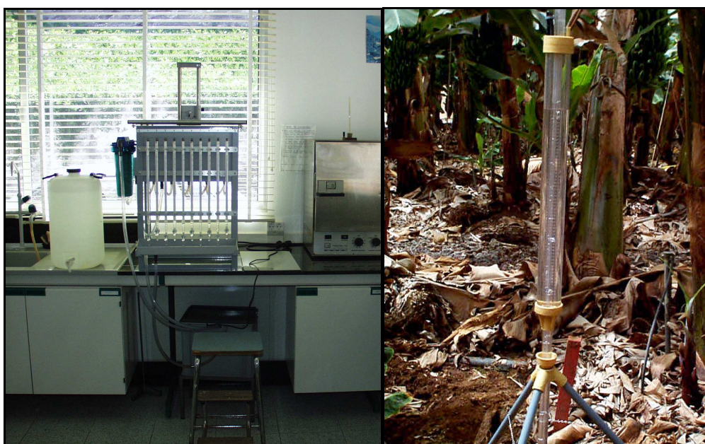
Foto 1. (a) Permeámetro de carga constante Eijkelmkamp y (b) permeámetro de Guelph para medida de la conductividad hidráulica saturada en laboratorio y en campo, respectivamente.
