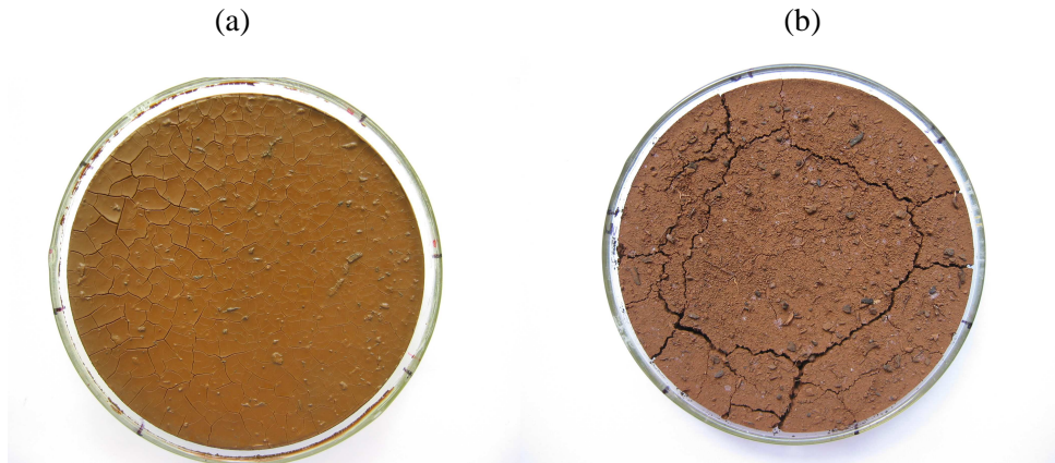
Foto 2. Ejemplos de muestras para medida de la retracción con fisuras o grietas, a) Muestra C4 P-2 y b) muestra N1 P1 , ambas a SAR 50.
