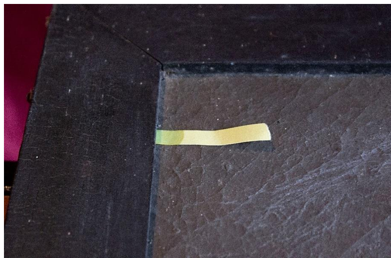
Fig. 59: Aplicación de la tira medidora de pH en el anverso de la obra comenzando a obtener el color correspondiente a su carácter
