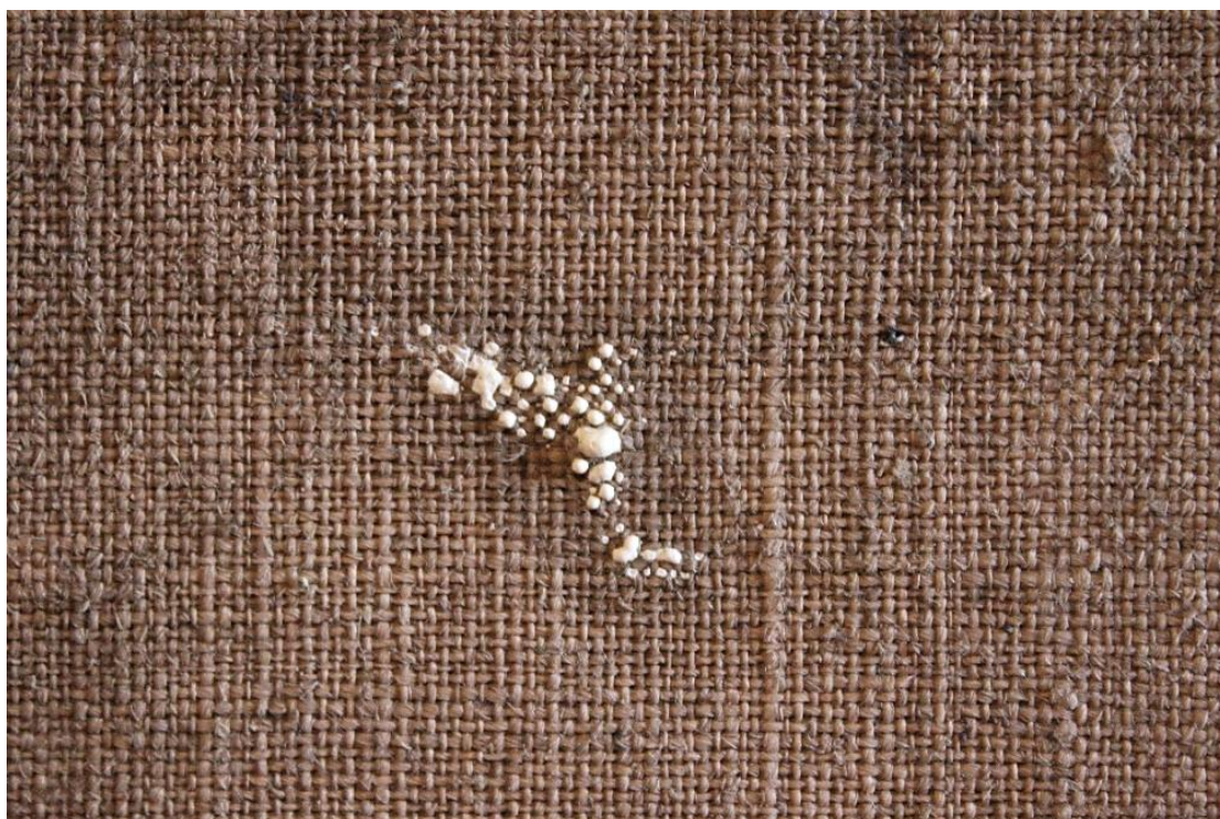
Fig. 68: La imprimación ha atravesado el soporte textil y forma gotas duras, los llamados “cojines”, en la parte posterior del cuadro (Knut 1999)
