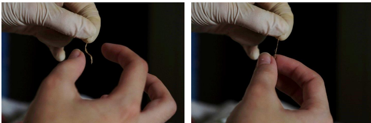
Fig. 50 (izq.): Muestra de hilo siendo torsionado hacia la derecha, en Z, dirección en la que se disponen las fibras pues estas se abren con facilidad; Fig. 51 (dcha.): Muestra de hilo siendo torsionado hacia la izquierda, en S.
