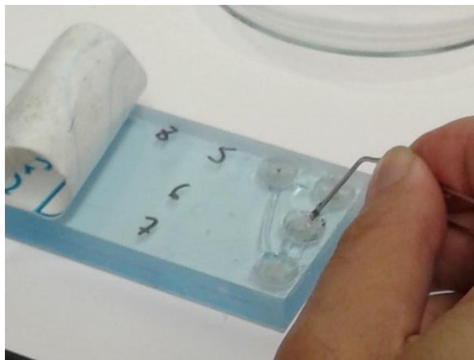
Fig. 60: Preparación de muestra estratigráfica en pieza de metacrilato realizada en los talleres de química de la Facultad de Bellas Artes (ULL)
