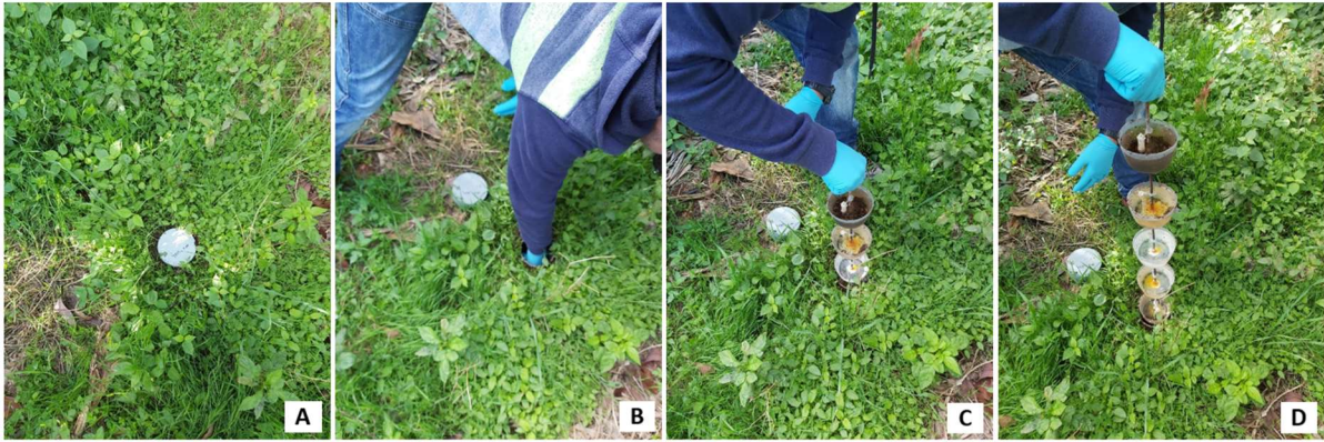
Figura 4. Extracción de las trampas para la recolección de las muestras. A: trampa cerrada; B, C y D: extracción de la varilla con los cinco recipientes.
