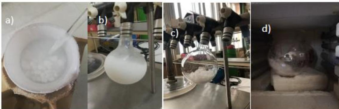
Fig. 8: Método de liofilización empleado en la muestra  $\text{La}_3\text{NbO}_7$ : a) Disolución congelada, b) inicio del proceso de liofilización, c) producto al finalizar el proceso de liofilización y d) tratamiento térmico a baja temperatura (300°C)
