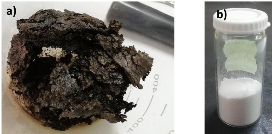
Fig. 40: Síntesis sol gel del compuesto  $\text{La}_2\text{YNbO}_7$ : a) precursor obtenido mediante sol-gel y b) producto final calcinado a 1000°C
