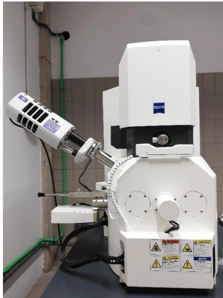
Fig. 13: Microscopio SEM ZEISS EVO 15 con resolución de 2 nm
