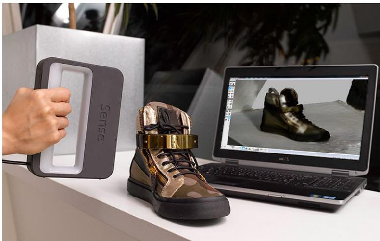
Figura 5. Escaneo de una bota con el escaner Sense 3D.
