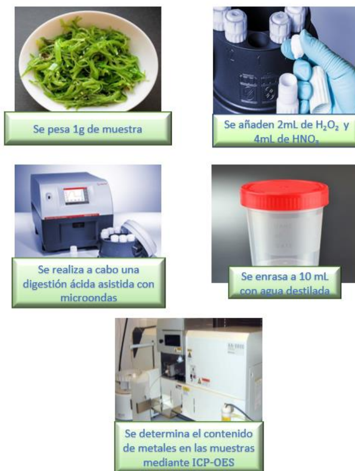
Figura 2. Esquema conceptual del procedimiento analítico
