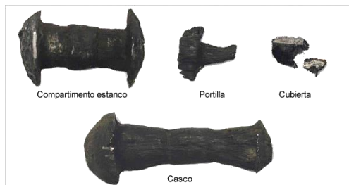
Ilustración 37. Diferentes tipos de remaches del Titanic.
