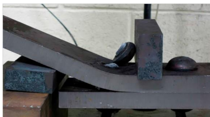
Ilustración 36. Ensaño de impacto (Charpy). Los remaches saltan al ejercer presión sobre la placa.
