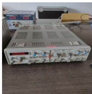
Figura 2.1: Imagen del generador de señal HM8030-3 de HAMEG utilizado en los diferentes ensayos y montajes en el laboratorio de BFmSD
