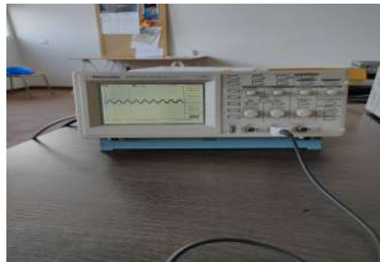
Figura 5.11: Señal obtenida por el piezoeléctrico comercial a 35KHz Señal obtenida por el osciloscopio del laboratorio de BFmSD.
