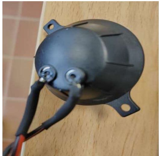
Figura 6.13: Imagen de la parte posterior de uno de los emisores tras ser conectado.
