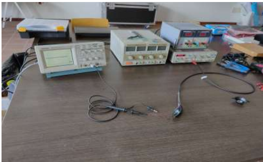
Figura 5.9: Montaje del ensayo de emisión a frecuencias superiores a 20KHz Montaje realizado en el laboratorio de BFmSD.
