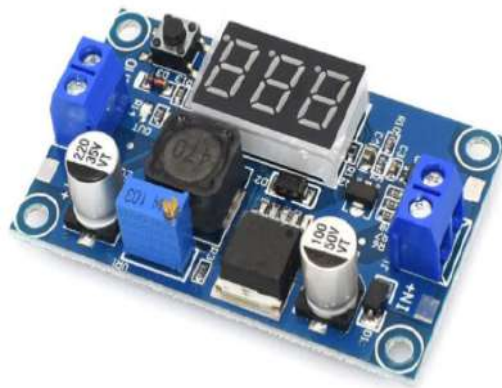
Figura 3.13: Imagen de la etapa “Step-up” seleccionado en el dimensionado de la etapa de amplificación de señal de este módulo
