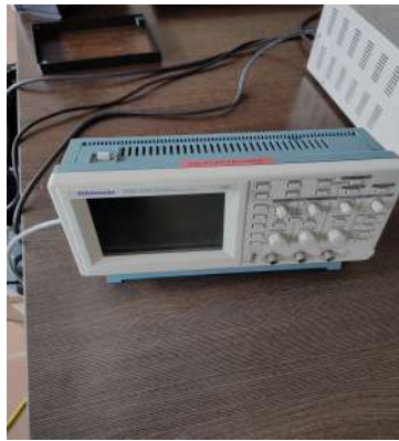
Figura 2.2: Imagen del Osciloscopio TDS210 de Tektronix utilizado en los diferentes ensayos y montajes en el laboratorio de BFmSD
