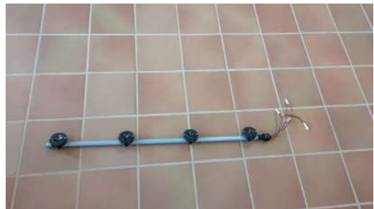
Figura 6.19: Imagen detallada de la fijación de las cápsulas cableadas al tubo portante
