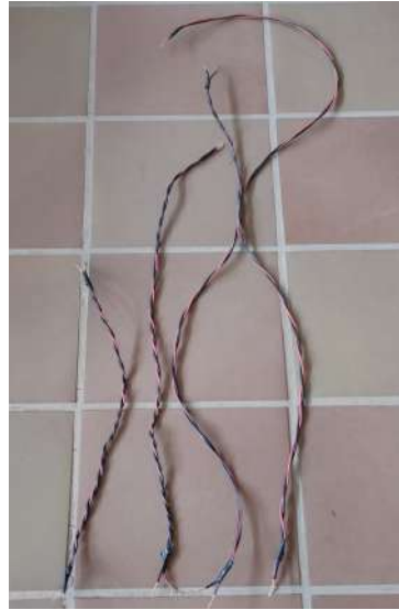
Figura 6.11: Imagen del trenzado de cable fabricado Imagen realizada en el laboratorio de BFmSD.
