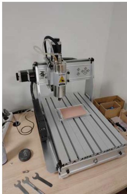
Figura 2.3: Imagen de la máquina de corte por control numérico disponible en el laboratorio de electrónica de la ESIT de la ULL usada para la fabricación de la “PCB”
