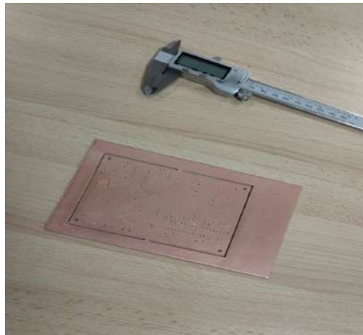
Figura 6.1: Imagen de la PCB tras realizarle los orificios y cortes necesarios Imagen realizada en el laboratorio de electrónica de la ULL.
