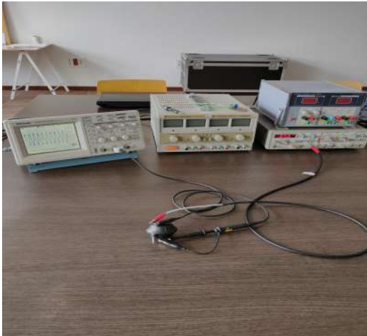
Figura 5.4: Montaje del ensayo de emisión a frecuencias superiores a 20KHz Montaje realizado en el laboratorio de BFmSD.
