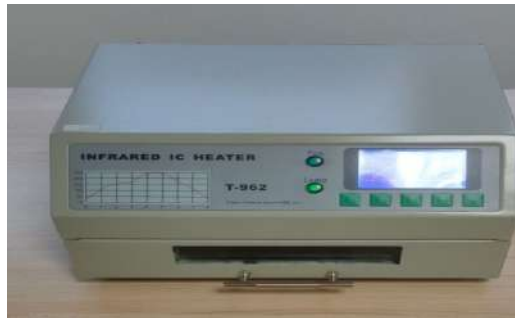
Figura 2.4: Imagen del horno T962 disponible en el laboratorio de electrónica de la ESIT de la ULL usada para la fabricación de la “PCB”
