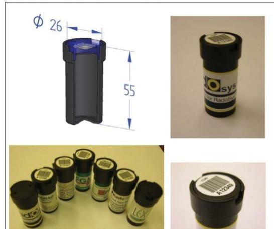
**Figura 12.** Muestras de un detector RSKS. Fuente: (Manual de Uso Radosys, 2013).
