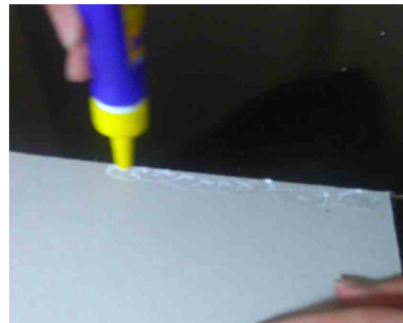
Encolado de la superficie del tablero
