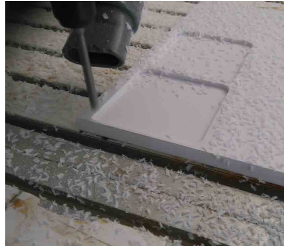
Fresadora realizando el corte en PVC
