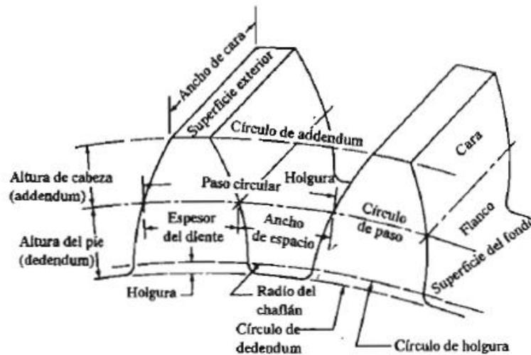
Figura 8: Propiedades de un par de engranajes. Fuente: Diseño de Elementos de Máquinas. Robert L. Mott. Editorial Pearson. Cuarta edición. 2006
