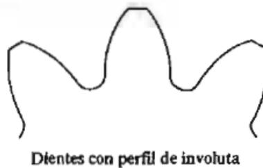
Figura 2: Perfil de involuta. Fuente: Diseño de Elementos de Máquinas. Robert L. Mott. Editorial Pearson. Cuarta edición. 2006
