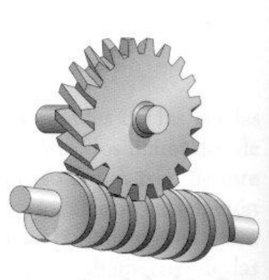
**Figura 8: Transmisión de tornillo sin fin**
