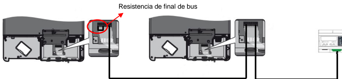
Figura 3: Conexión entre un CDP y varios inversor.
