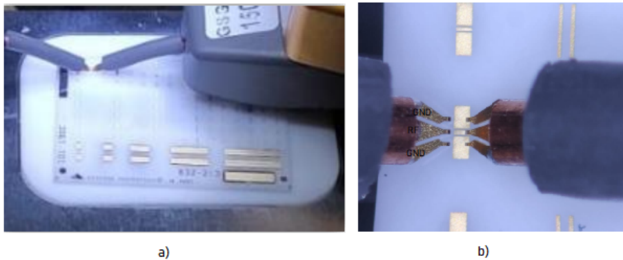
Figura 4.2 a) Posado sobre sustrato y b) estructura de las puntas ( 150\ \mu\text{m} pitch) [26].
