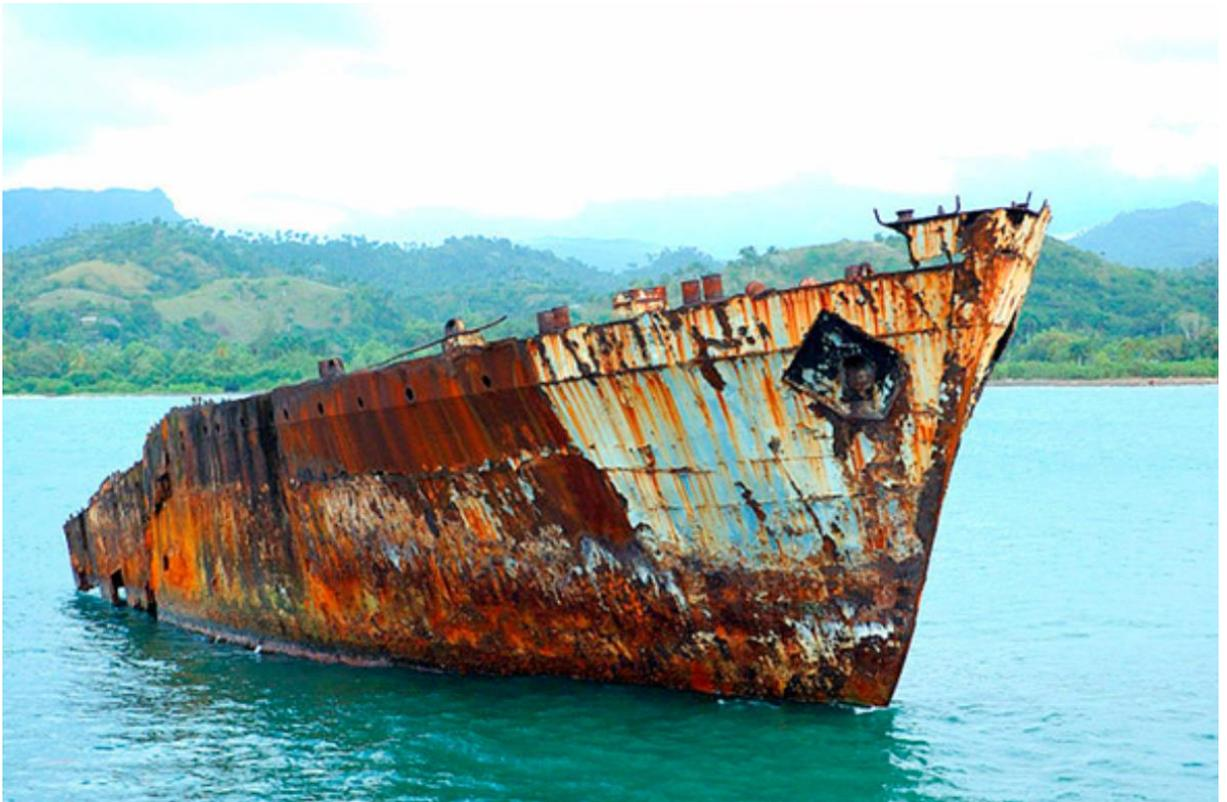
Ilustración 2. Buque bajo graves efectos de corrosión. Fuente: [Uniservice | Descubre cómo evitar la corrosión de tu barco \(uniservice98.com\)](https://www.uniservice98.com)
