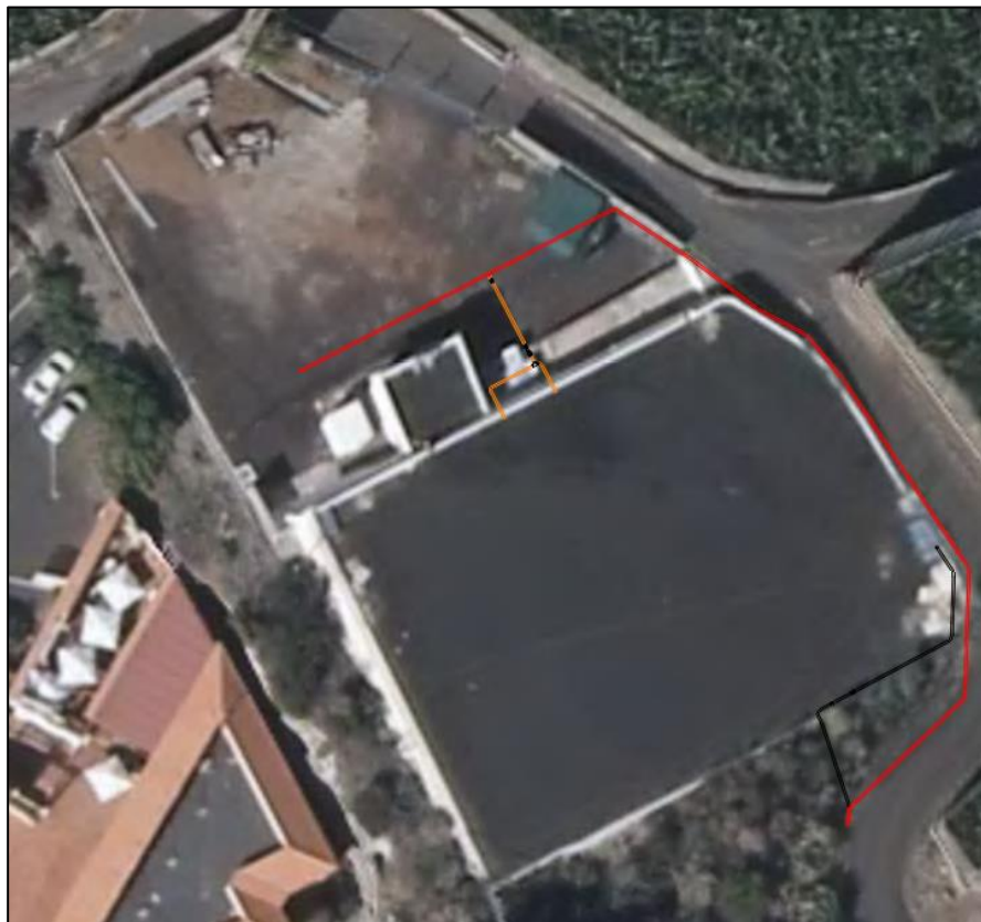
Ilustración 6. Conducción entrada actual (Negro), conducción entrada sistema de filtración (Rojo) y entrada directa (Naranja).
