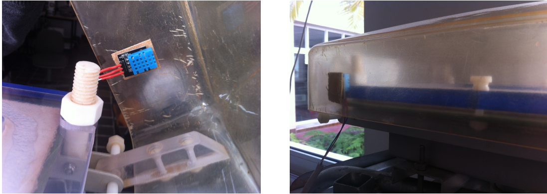
Figura 10: Posición Sensor Humedad DHT11 en Captador de Muestras
