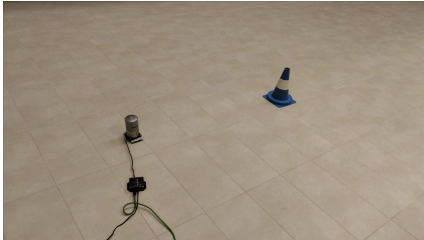
Figura 4.5: Imagen mientras se adquirían datos para implementar la lógica difusa, con Velodyne HDL-32E
