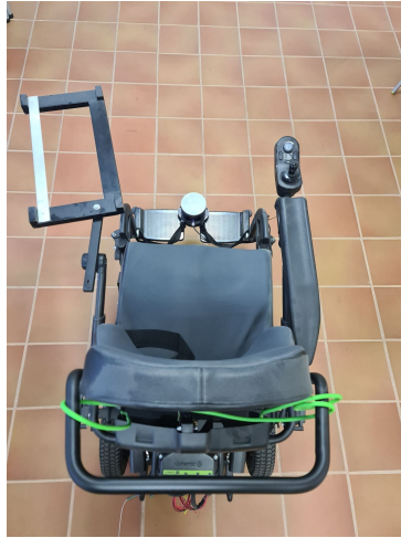
Figura 3.11: Montaje del LIDAR Robosense RS-LiDAR-16 en silla Vermerien
