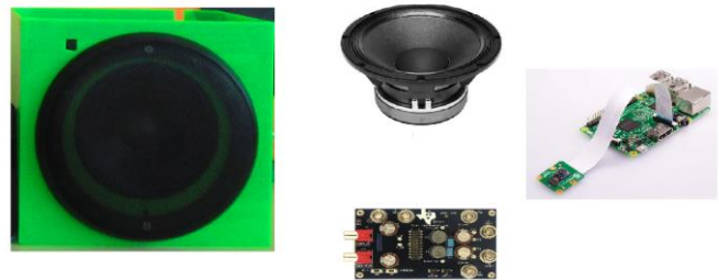
Fig. 6. Megáfono IP y CCTV IP junto con su hardware
