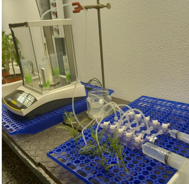
Figura 4: Sistema de medición de flujo por gravimetría. Consta de un cuadro de llaves de paso al que se conectan hasta 5 hojas o ramitos a la vez, y que permite regular el flujo de agua de cada muestra independientemente para que vaya al depósito de la balanza o al auxiliar. En la imagen están conectados ramitos de *Lavandula canariensis* colocados para que la luz les llegue a todas las hojas por la cara adaxial.
