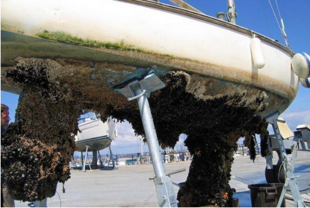
Ilustración 7: Incrustaciones de tipo alga en la obra viva del barco
