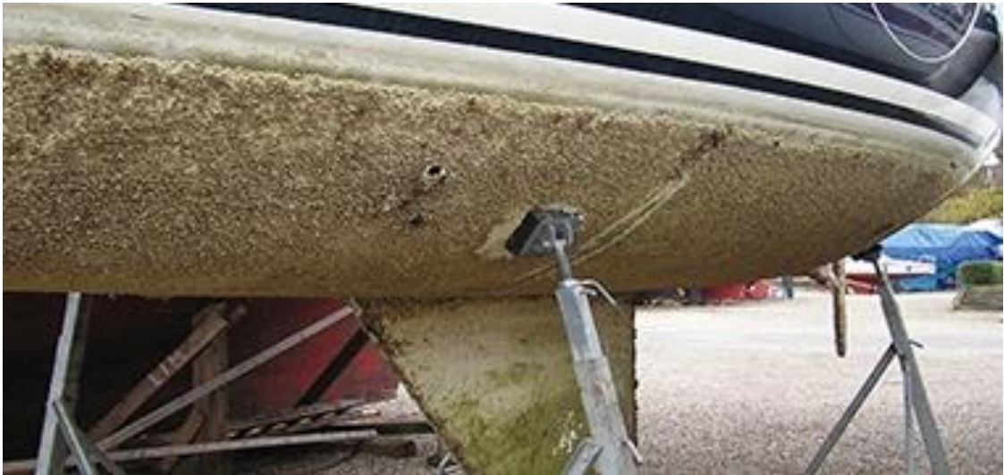
Ilustración 5: Barco con casco cubierto de incrustaciones tipo limo
