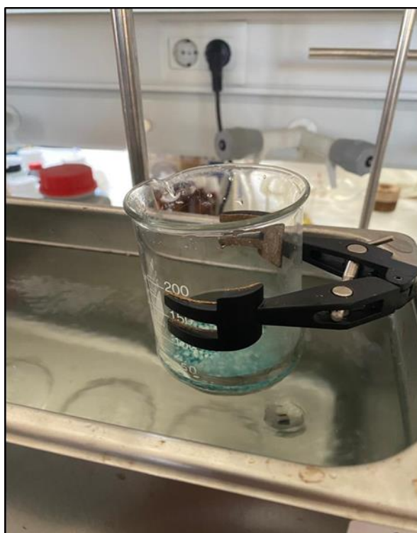
Figura 2.2: Catalizador Pumita - Cobre en baño de ultrasonidos.
