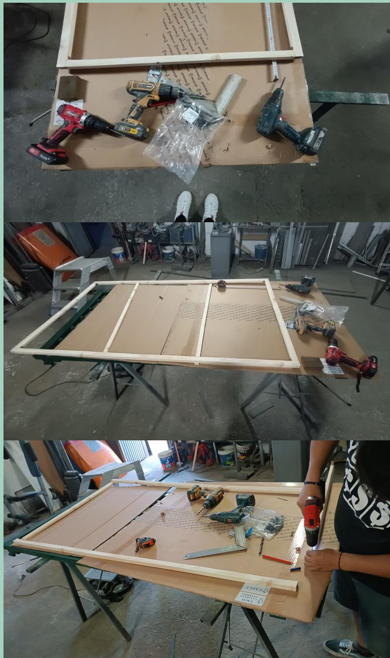
Fig. 74 Proceso de montaje de los bastidores.
