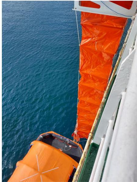
**Ilustración 19:** Sistema MES y balsa salvavidas desplegados. Fuente: trabajo de campo.
