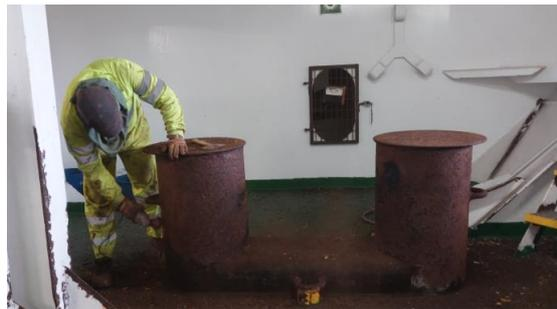
**Ilustración 17:** Personal de cubierta realizando labores de lijado en las vitas. Fuente: trabajo de campo.
