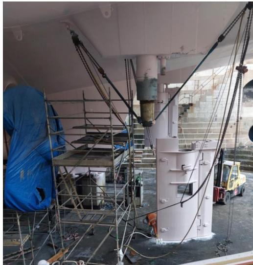
**Ilustración 20:** Timón de babor imprimado para su posterior colocación. Fuente: trabajo de campo.
