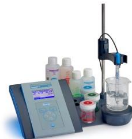
Figura 4. Sistema empleado en este TFG para la medida de pH. Imagen tomada de la página comercial.
