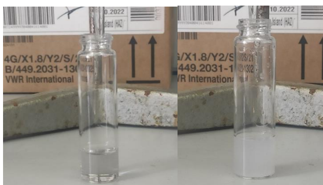
Figura 7. Se puede observar el perfume antes (izquierda) de que se le añada agua y después (derecha) de añadir el agua. Se puede observar la ruptura del sistema monofásico.
