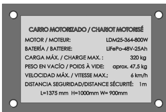
Figura D.23 – Detalle del modelo CAD de la placa [fuente propia]
