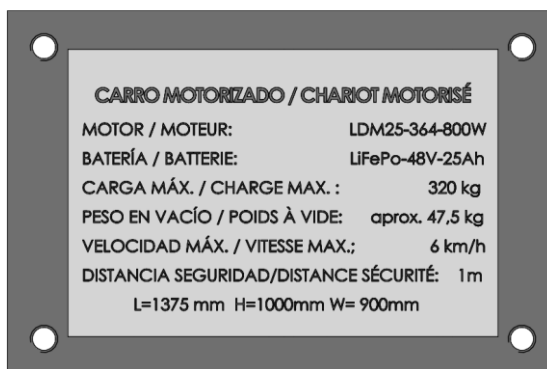
Figura 26 – Detalle del modelo CAD de la placa de identificación [fuente propia]
