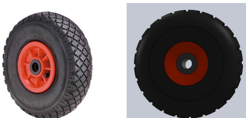
Figura C.30 – Imagen de la rueda seleccionada (izq.) y su modelo CAD (dch.)
