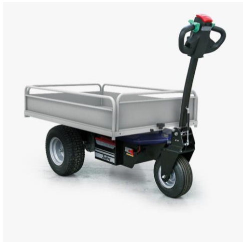
Figura 3 – Carro motorizado simple de 3 ruedas [Disset Odiseo]
