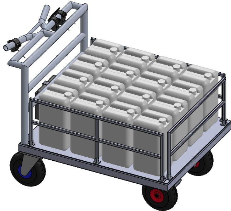
Figura D.27 – Modelo CAD del carro motorizado - vista con bidones [fuente propia]
