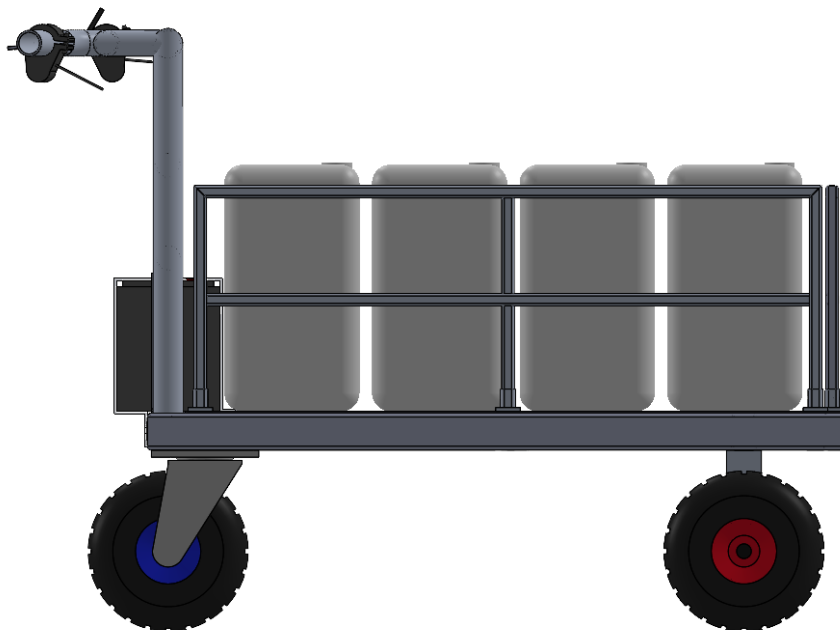
Figura D.28 – Modelo CAD del carro motorizado - vista lateral con bidones [fuente propia]
