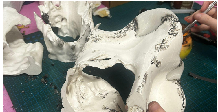
Figs. 82 y 83. Fotos del proceso de lijado y encolado de las piezas de filamentos (2023).
