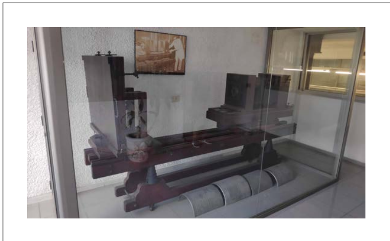
Figura 72: Máquina de reproducción fotográfica y estereotipos curvos, conservados en las instalaciones de El Día en la Avenida de Buenos Aires de Santa Cruz de Tenerife. (Recuperado de: archivo del autor).
