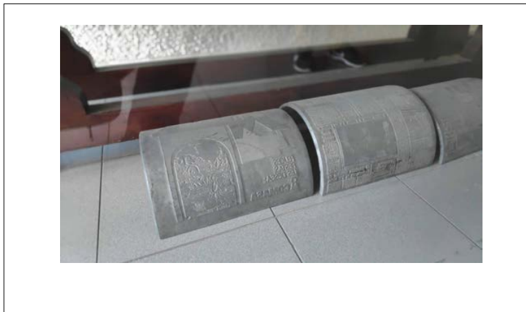
Figura 31: Estereotipos curvos utilizados por el diario El Día en las primeras décadas del siglo XX. (Recuperado de: archivo del autor).
