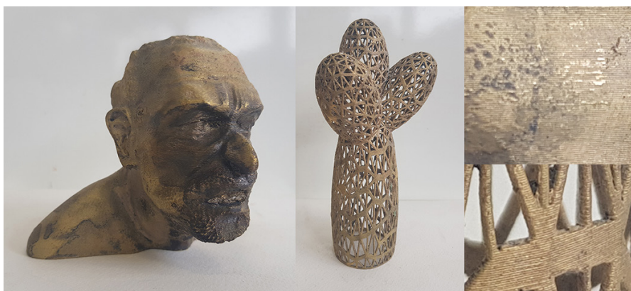
Figura 5A. Busto figurativo, realizado con fundición de PLA-perdido; Figura 5B. Síntesis figurativa realizada con fundición de PLA-perdido; Figura 5C. Detalle de superficie con tratamiento de homogenización; Figura 5D. Detalle de superficie sin tratamiento. (Fuente: Fotografía del autor).
