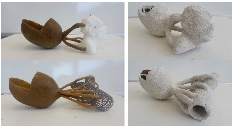
Figura 4A. Modelo en PLA con el árbol de fundición con sus bebederos y crisol que generará un conjunto mixto de ambos materiales (cera-PLA); Figura 4B. Piezas con el recubrimiento de la cascarilla cerámica. (Fuente: Fotografía del autor).
