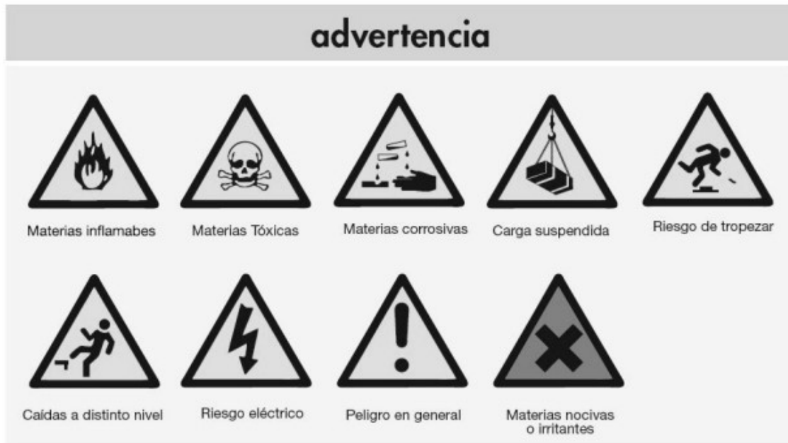
Imagen 45. Señalizaciones de advertencia en una instalación fotovoltaica.
