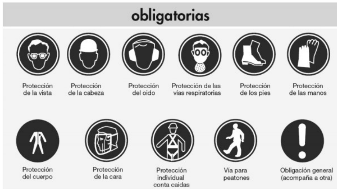
Imagen 46. Señalizaciones obligatorias en una instalación fotovoltaica.
