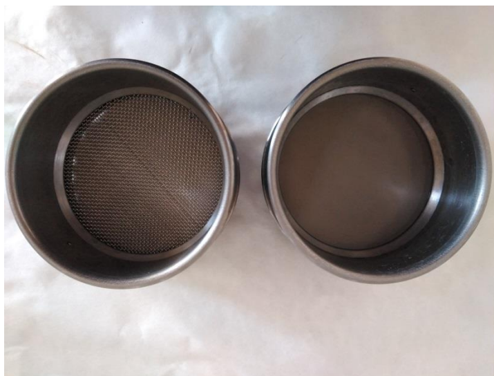
Figura 9.- Representación de las dos cribas utilizadas en el procesamiento de las muestras de suelo. A la izquierda se muestra la criba de 1mm que retiene a la macrofauna; a la derecha la criba de 45µm por donde se pasa el poso.
