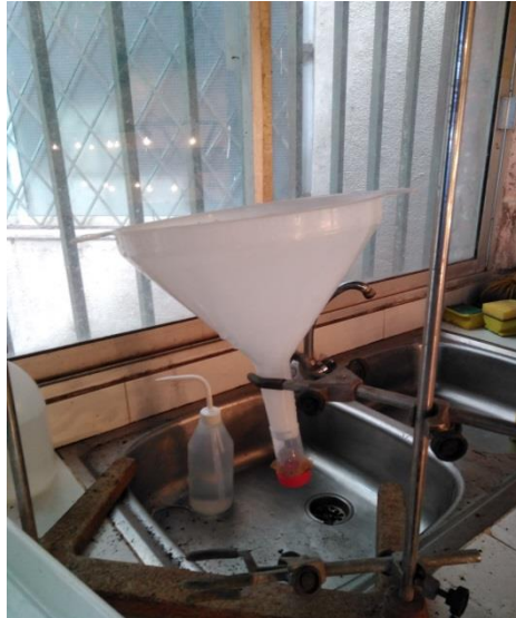
Figura 8.- Embudo conectado a una gasa para el filtrado del agua y retención de los especímenes que contiene la bandeja inferior del Berlese.
