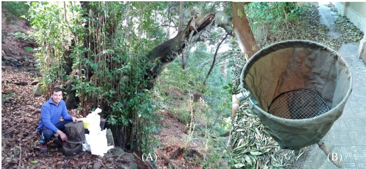
Figura 6.- (A) Tamizado de la parte superficial mediante el aparato Winkler en el Barranco de Ruiz. (B) Aparato Winkler empleado para tamizar la capa superficial, en cuyo interior se muestra la rejilla para el cribado.
