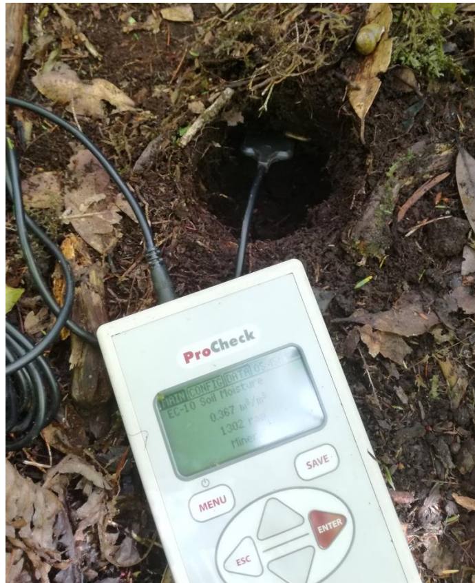
Figura 6. ProCheck . En la fotografía se puede observar el proceso de medición del contenido hídrico de la capa orgánica del suelo. La sonda se coloca en el hueco que deja la trampa.
