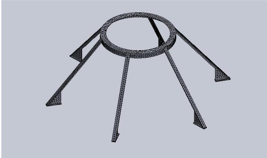
Fig. III.23 - Mallado de la estructura superior
