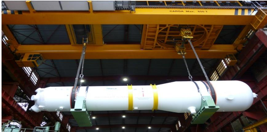
Imagen VIII. Generador de Vapor Ensa
