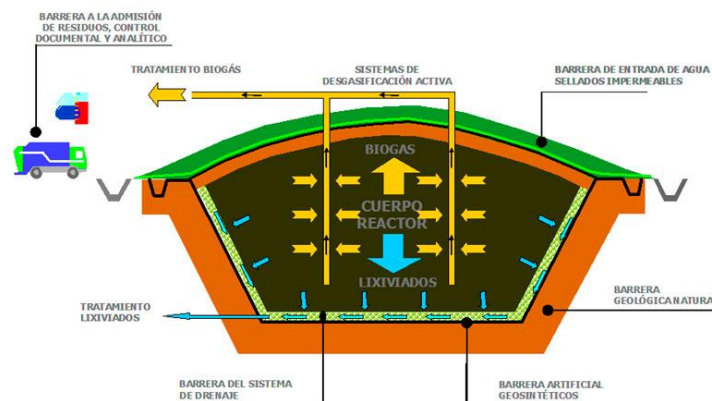
Figura 6: Sección sistema tratamiento de lixiviados [21]
