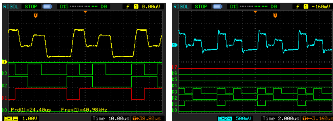
Figura 5.13. Comparación de señales a la salida del módulo emisor digital (imagen de la izquierda) y a la salida del receptor (imagen de la derecha).
