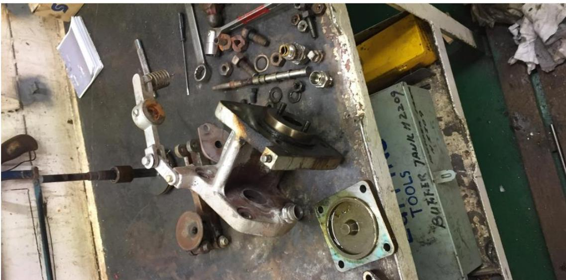
**Ilustración 45.- Despiece regulador de presión constante, actuador, y cover oil relay**
