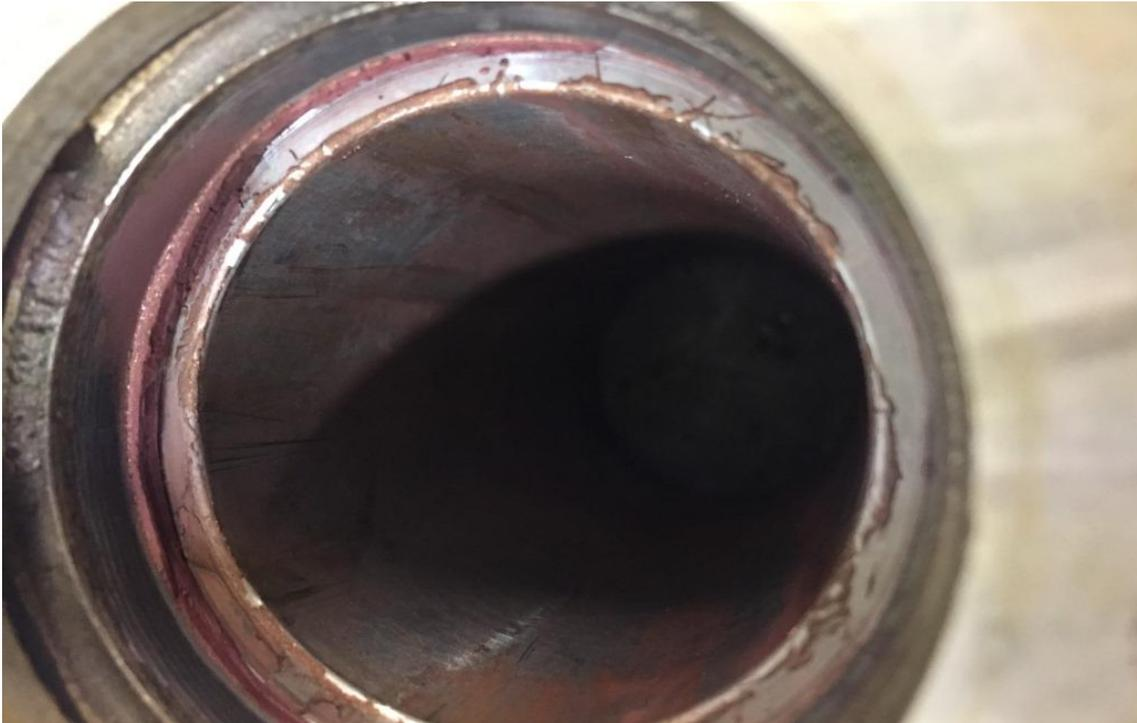
**Ilustración 44.- Detalle deterioro seal cover. Fuente, Elaboración propia.**
