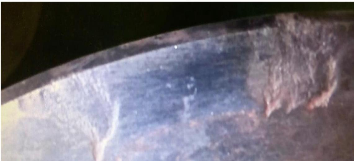
**Ilustración 42.- Detalle cavitación impeler. Fuente, Elaboración propia.**
