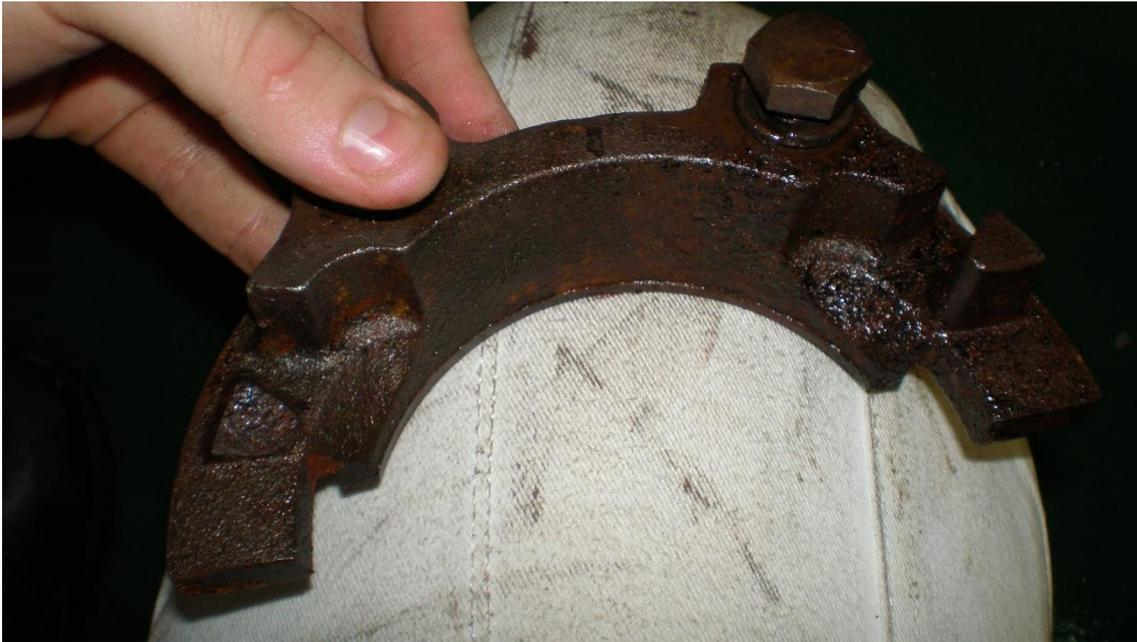
**Ilustración 48.- Detalle corrosión cojinete de apriete seal cover. Fuente, Elaboración propia.**
