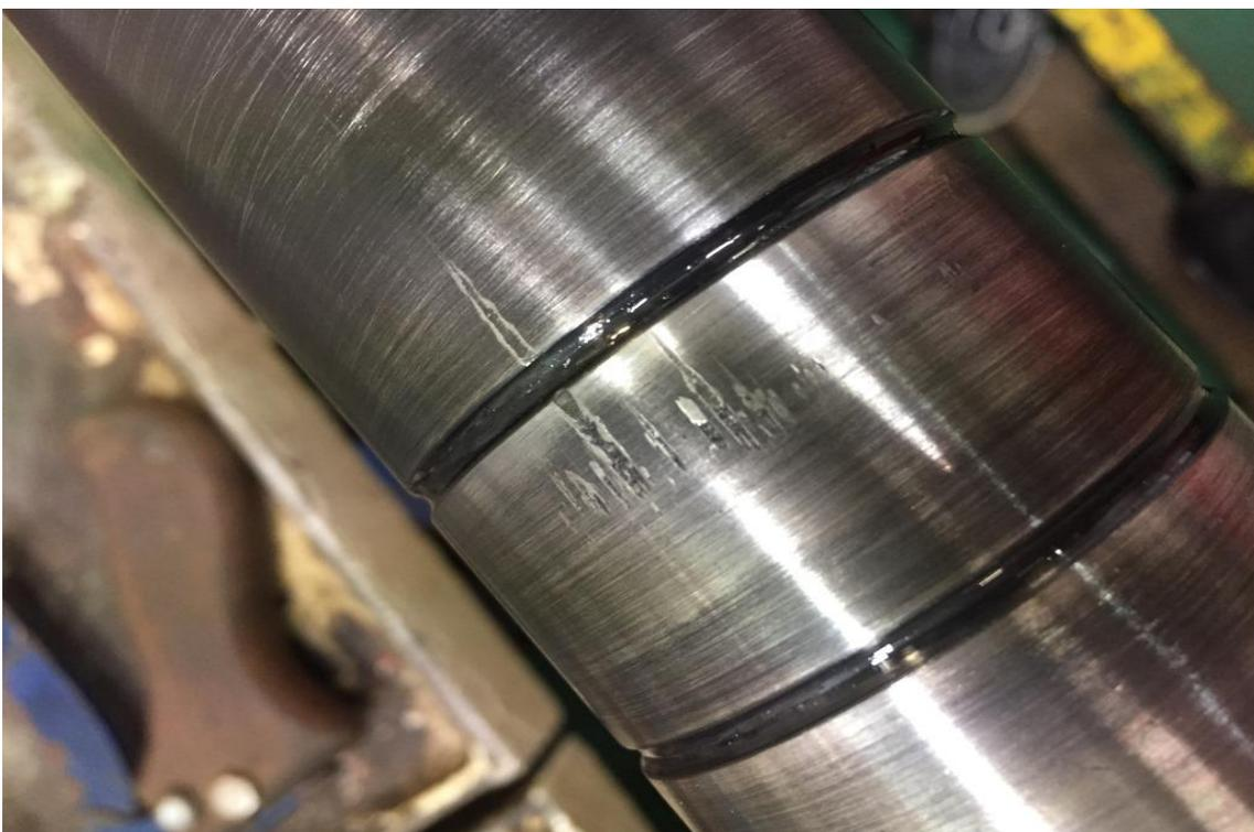
**Ilustración 37.- Detalle del eje arañado. Fuente, Elaboración propia.**
