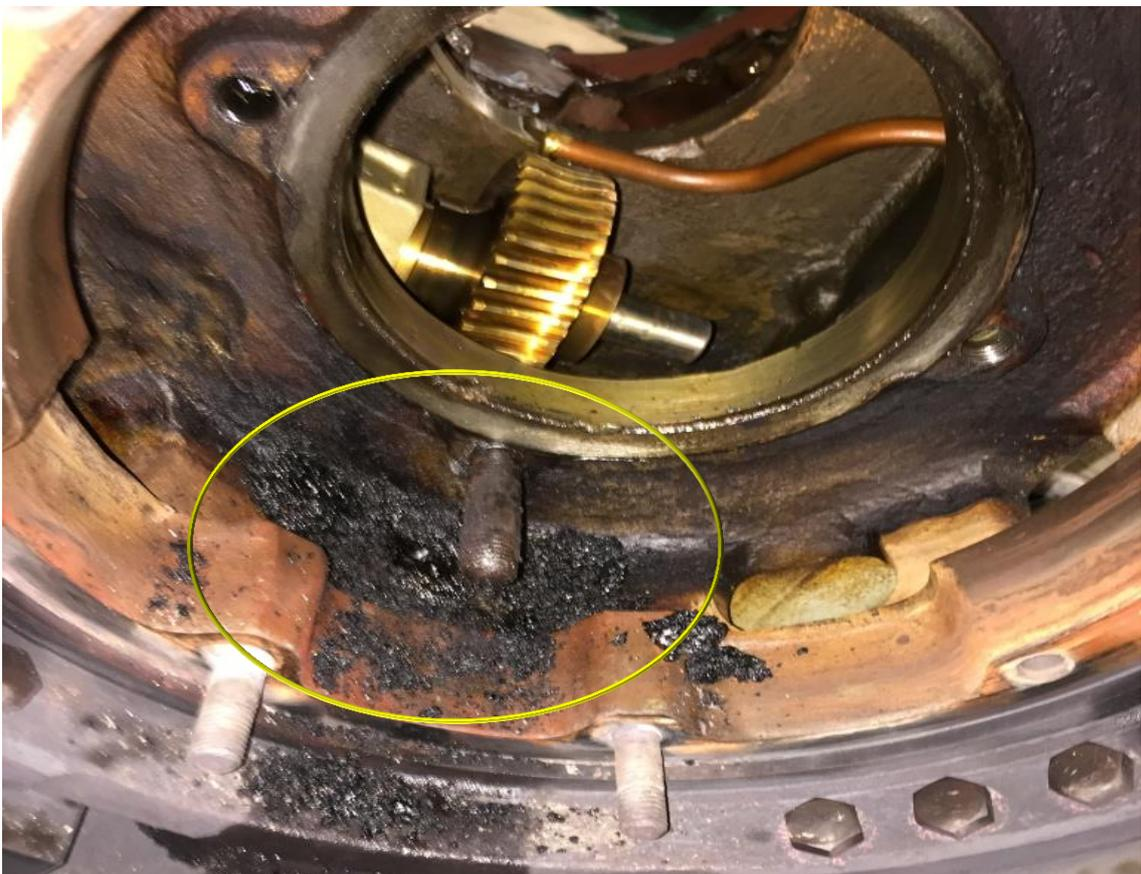
Ilustración 34.- Residuos lado de vapor. Fuente, Elaboración propia.
