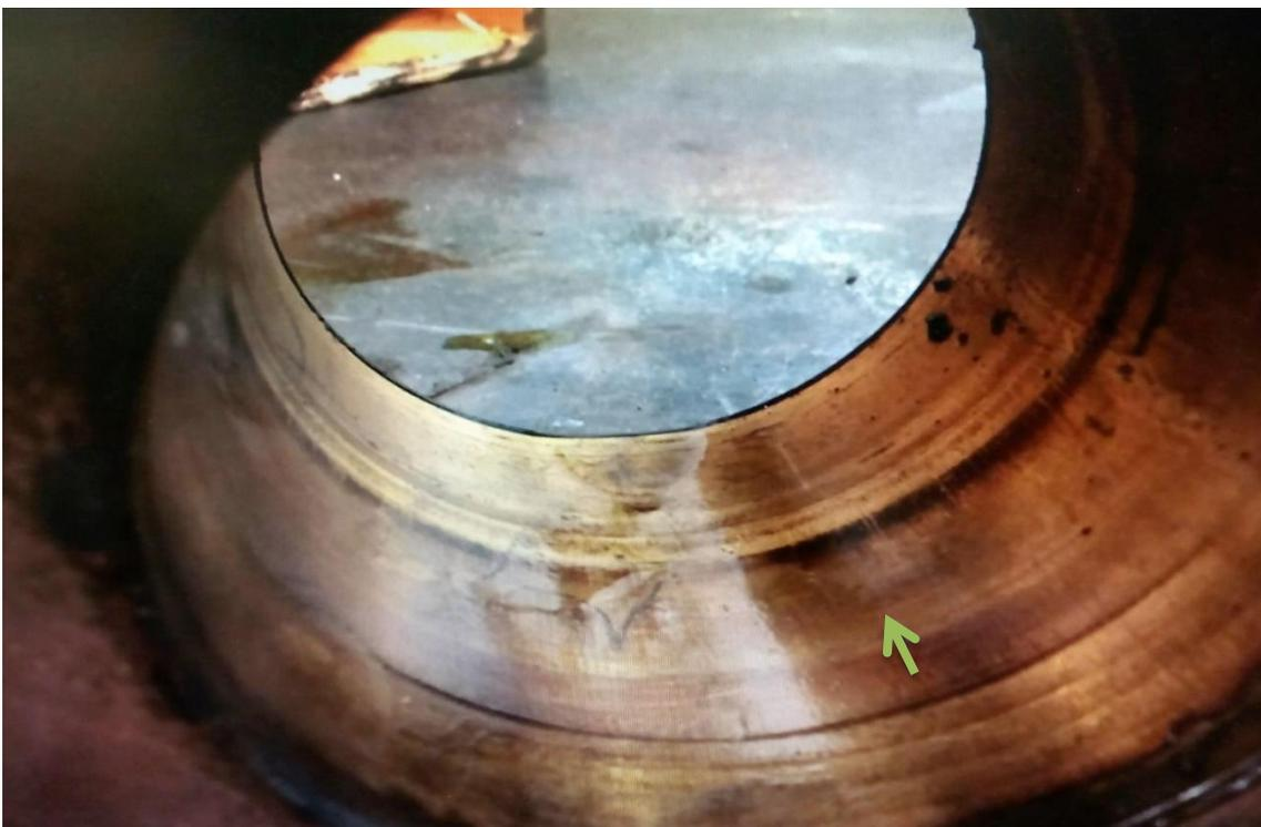
**Ilustración 47.- Detalle desgaste manguito, Elaboración propia.**
