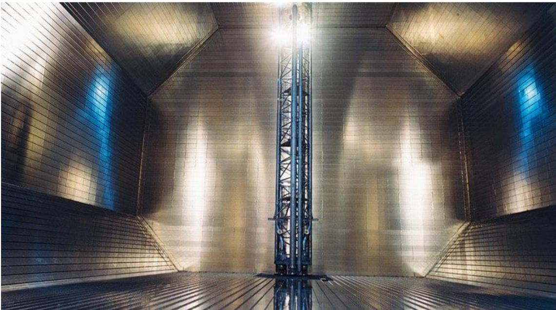
**Ilustración 11.- Interior de un tanque de carga Gaz Transport. Fuente [11]**
