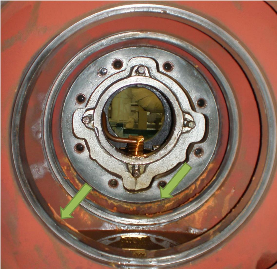
**Ilustración 32.- Puntos de corrosión localizada en el lado de la bomba. Fuente, Elaboración propia.**
