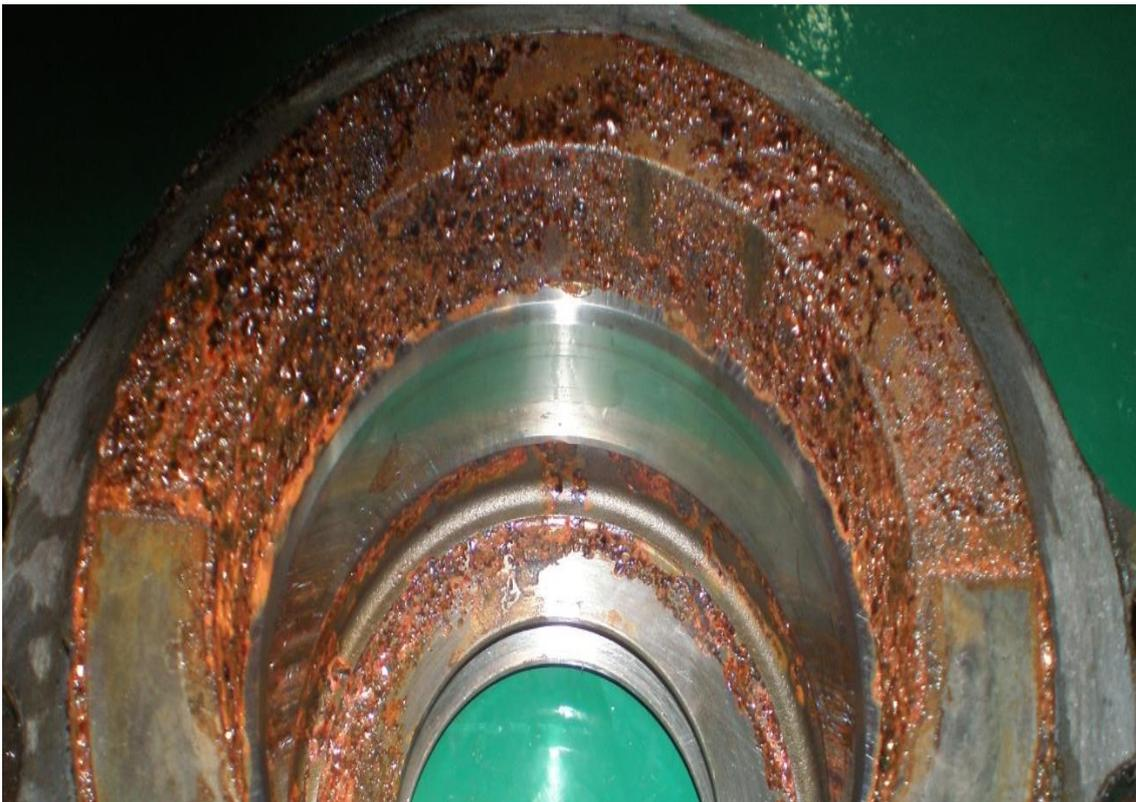
**Ilustración 43.-** Desgaste y corrosión en la cara de ajuste. Fuente, Elaboración propia.
