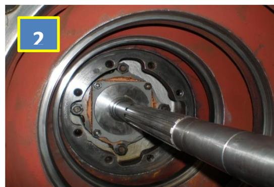
**Ilustración 49.- Montaje del eje en su posición. Fuente, Elaboración propia.**
